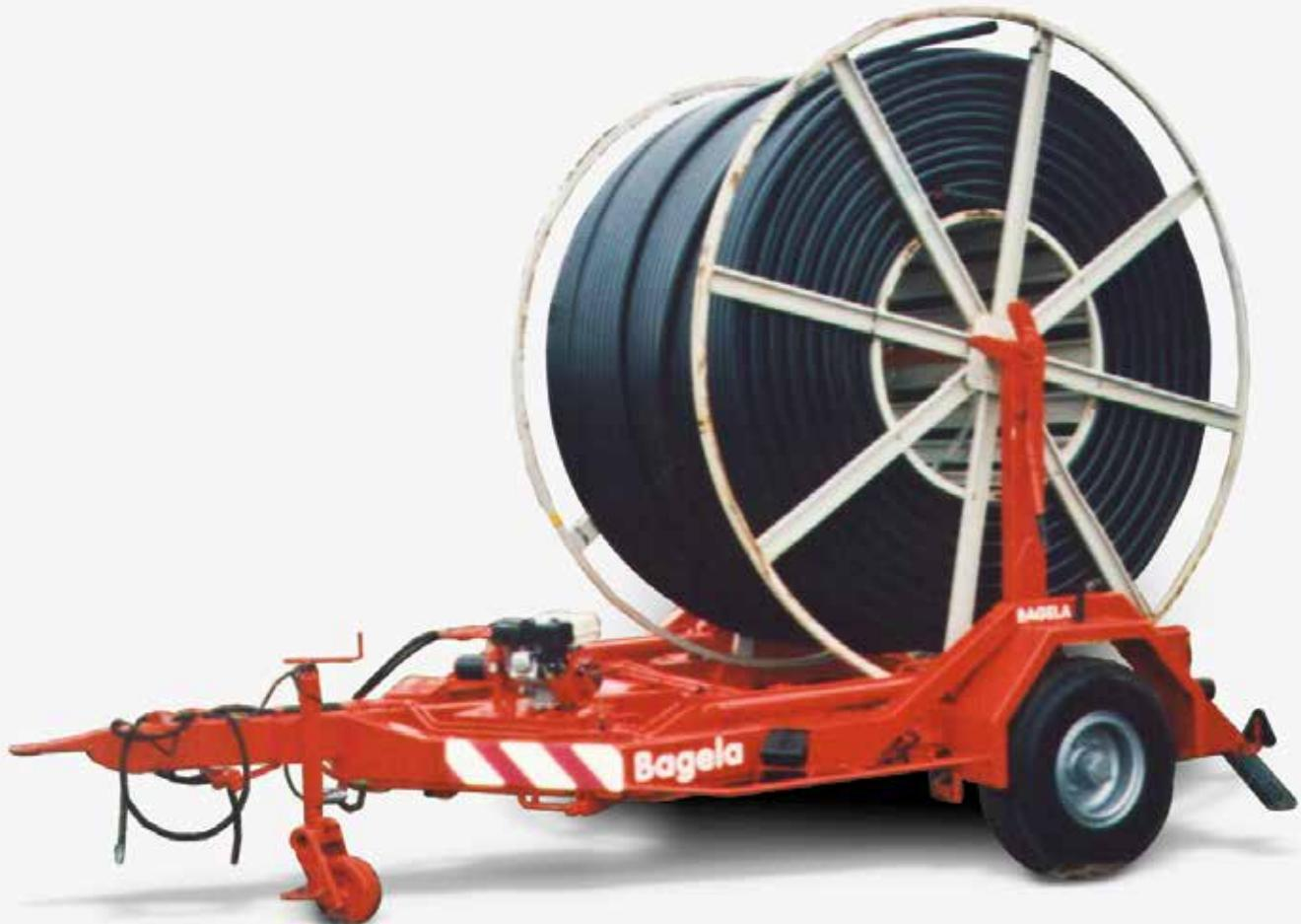
Dieser Kabelwagen ist das typische Transport- und Verlegefahrzeug für die Ortsnetzverkabelung.
