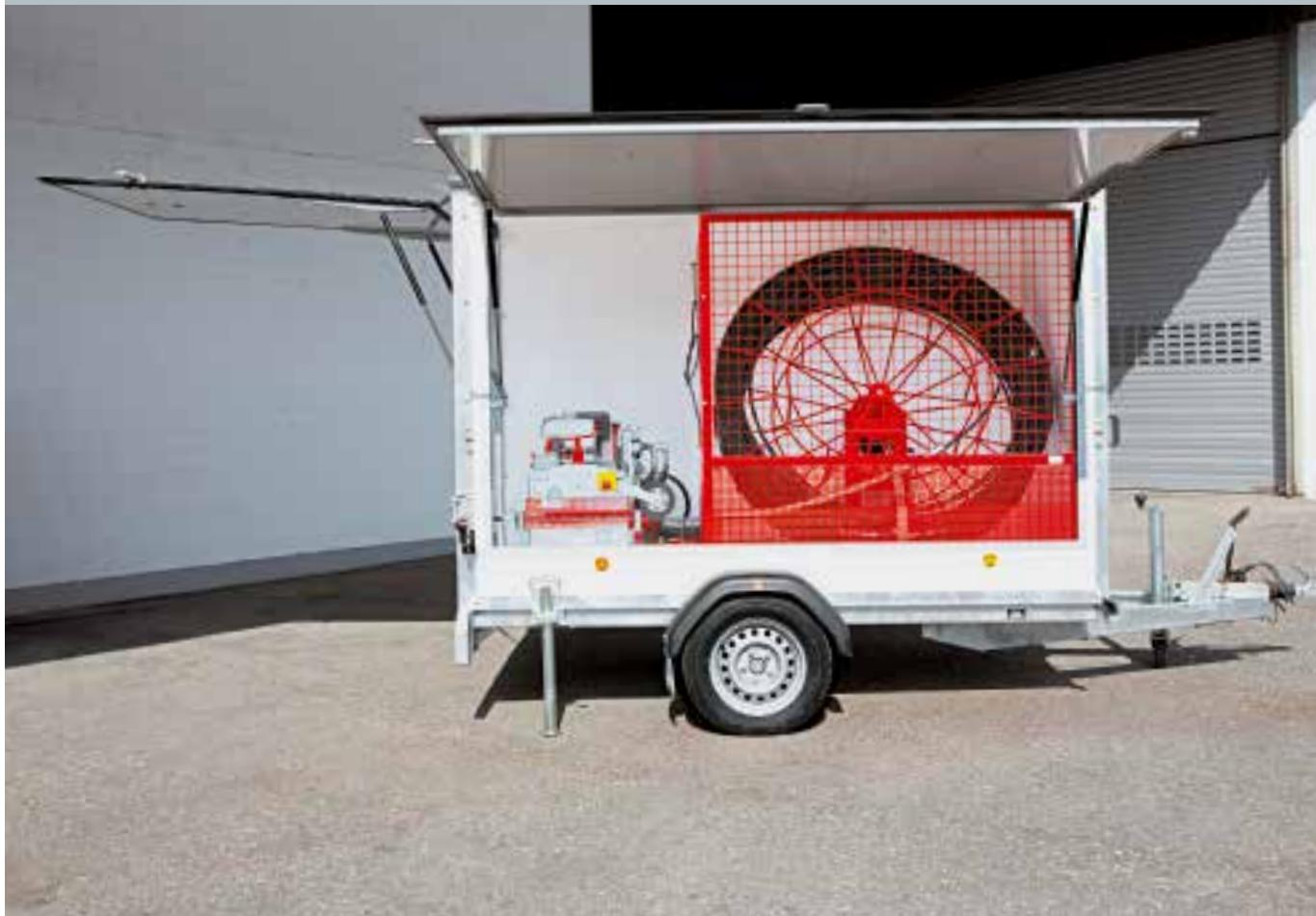
Der Kessler-Jet ist ein Einschiebeband-Anhänger. Die im Anhänger fest montierte Röhrenschlange wird mit Raupen durch den Honda-Motor HP 9 problemlos in leere oder schon belegte Rohre eingeschoben. Kabel oder Seil werden angehängt und beim Zurückziehen der Röhrenschlange in das Rohr eingezogen. Eine raffinierte Lösung für unkomplizierten und zeitsparenden Kableleinzug. Die Länge der Röhrenschlage ist von 300 – 600 m möglich.
