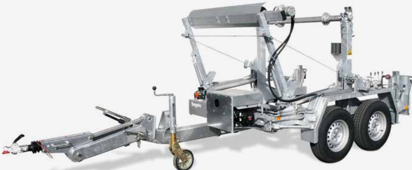
Bei dieser Baureihe erfolgt die Beladung über einen Kippladerahmen, der durch zwei Hydraulikzylinder abgesenkt und angehoben wird.
