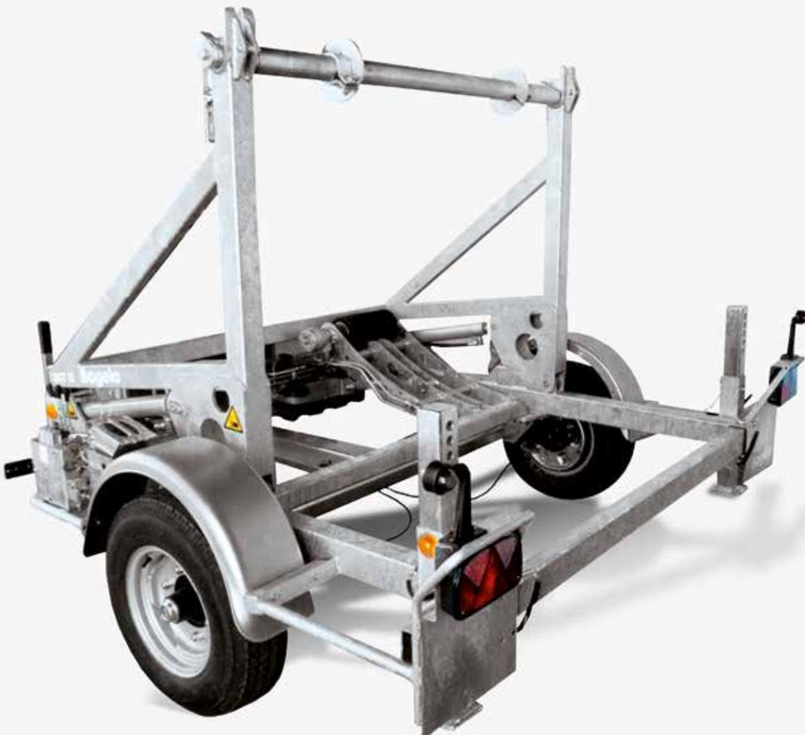
Die beiden parallel schwenkbaren Aufnahmeständer werden motorhydraulisch über zwei Hydraulikzylinder aufgehoben und hydraulisch abgesichert. In Verbindung mit dieser Ausstattung ist ein einseitiger Trommelantrieb mit 1 Gummiwalze und hydraulischem Andruck montiert. Für die notwendige Standsicherheit, während der Be- und Entladung im abgekuppelten Zustand, sorgt das vordere Abstellstützrad und zwei ausziehbare hintere Stützen.
