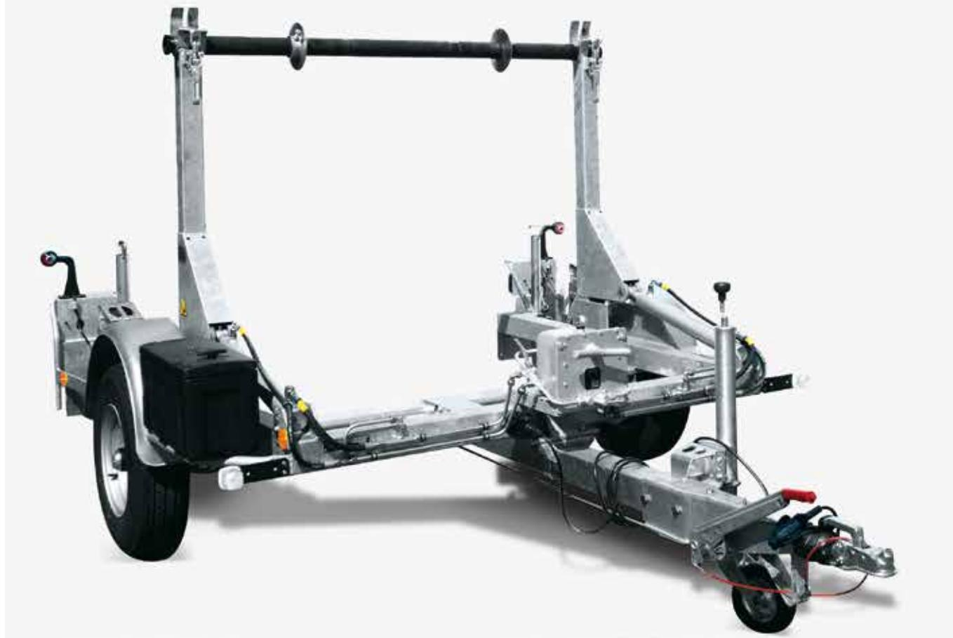
Der BKT 10 – 15 wird durch zwei Schwenkkarne mit einer manuell betriebenen Hydraulikhandpumpe und den beiden doppeltwirkenden Hydraulikzylindern beladen. Auf Wunsch können alle Wagen mit ausziehbaren Ladearmen zur Aufnahme von Rohrbundhaspeln geliefert werden. Es können dann Rohrbunde auch mit grösserem Durchmesser als die angegebenen maximalen Trommeldurchmesser transportiert und abgespult werden.
