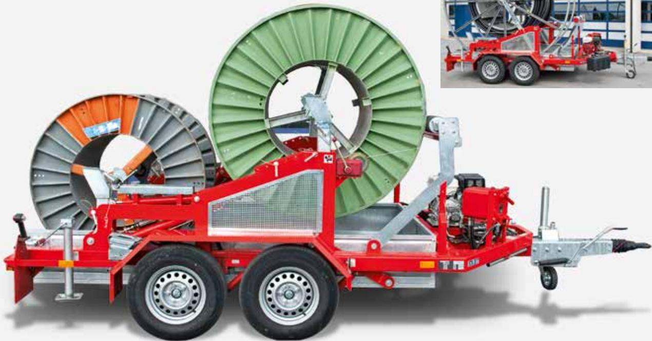
Der Rahmen ist in U-förmiger Bauweise aus Profilrohren gefertigt und mit einem hydraulisch absenkbarer Ladeboden versehen. An der Rahmenhinterseite sind zwei Stützfüsse montiert. Der Anhänger mit gerader Zugdeichsel (Höhe 470 mm im beladenen Zustand) und DIN-Zugöse ist auflaufgebremst und mit einer Rückfahrautomatik ausgestattet. Die max. Stützlast beträgt 150 kg.
