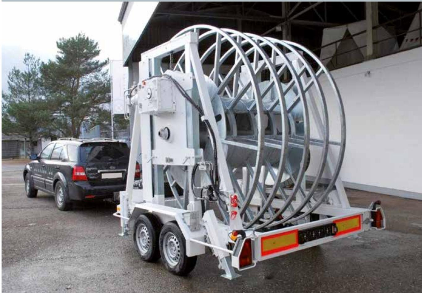
Für ein etwas anderes Geschäftsfeld ist der Trommelwindenwagen TW 35. Mit dem Anhänger werden Wärmesonden bis 500 Meter unter die Erdoberfläche in ein vorgebohrtes Loch eingeschoben.
